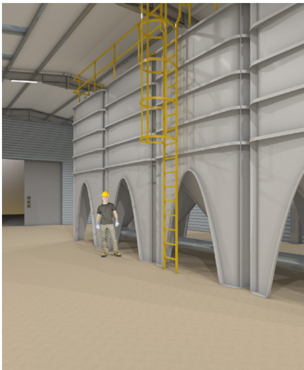
La montarea mai multor silozuri în serie, se livrează o pasarelă de protecție.
