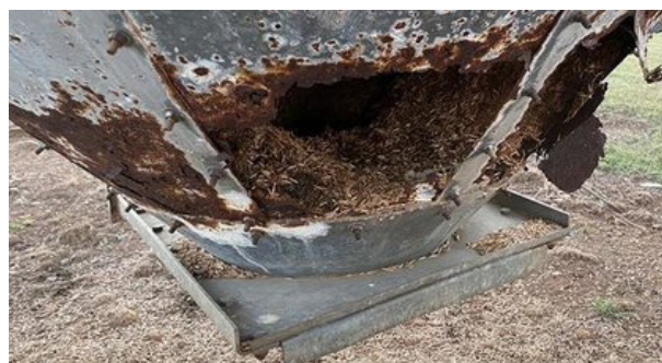
Silozurile din fibră de sticlă nu se corodează! Sarea și amoniul din furaje, combinate cu condensarea apei, duc la coroziune, la care materialele compozite sunt rezistente.
